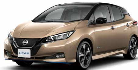
↑EV車の代表車、日産リーフ。上記は2017年よりフルモデルチェンジされた2代目リーフこと、ZE1型。ZE1型は2019年より大容量バッテリーモデル「リーフe+(イープラス)」として進化を遂げた。リーフe+は、62kWhのリチウムイオンバッテリーを搭載、航続距離はJC08モードで570km、WLTCモードで458kmとなり、急速充電時の対応最大出力も100kWに向上された。
