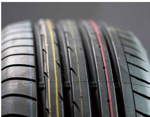
↑深い縦溝が雨水などを排水する。タイヤが摩耗し、溝が少なくなってくると排水機能も落ちてしまうのでスリップしやすくなってしまいます。悪天候走行時にとても危険なので早めにタイヤを交換しよう。
