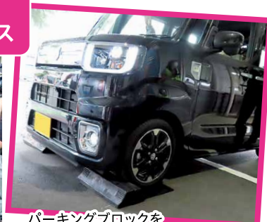
パーキングブロックを乗り越えようとする と誤発進抑制制御機能が作動します。
