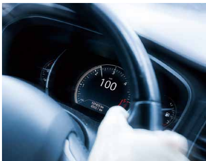
↑「速度警告音」は、普通車では100km/h以上、軽自動車は80km/h以上に達すると注意喚起として鳴らされるものでした。高速道路では、警告音が連続して鳴り続けることもしばしば……。
