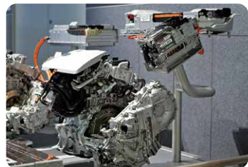
↑こちらはトヨタ プリウス(4代目/W50)の エンジンとハイブリッドシステム。 ハイブリッドカーはリチウムイオンバッテリー を搭載するのでその分さらに重くなる。
