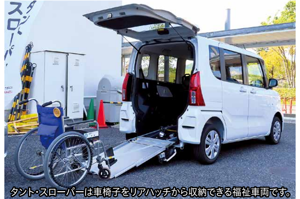
タント・スローパーは車椅子をリアハッチから収納できる福祉車両です。
